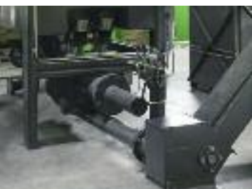
Holzkohlekoks wird hydraulisch aus dem System ausgeschleust. Über Schnecke und Kettenförderer gelangt er in einen Sammelcontainer.
